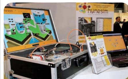
La plate-forme hynesim (en fonctionnement sur l'ordinateur) peut être connectée à un équipement réel, ici un automate de station de production d'eau potable, installé dans une valise pour la démonstration.
