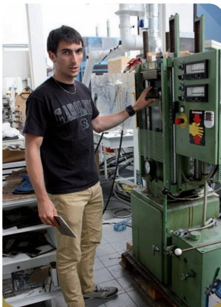
Grâce à une presse spécifique, les chercheurs peuvent fabriquer des plaques de biocomposite d'un demi-mètre carré en laboratoire.
